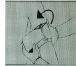
4 Tirer fermement en arrière pour forcer la barre de pression sur le coussinet.
